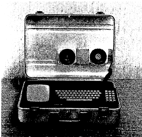
Abb. 35: Das mobile Btx-System hat die Größe eines Aktenkoffers und ist an jedem Telefongerät einsetzbar (Foto: Blaupunkt)
